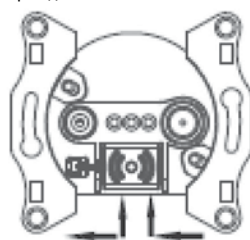
Розетка TV/SAT, проходная
